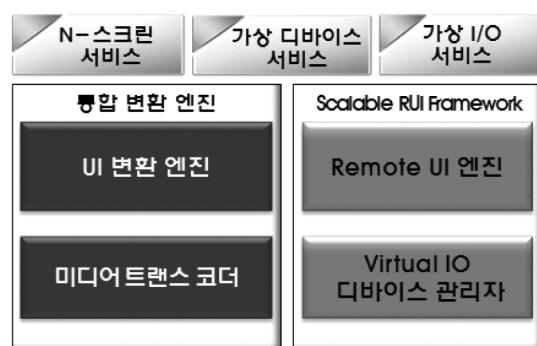
그림 1. N-스크린 원격 사용자 인터페이스 시스템 구조도
