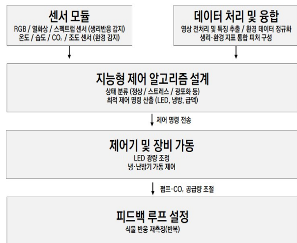
그림 2. 작물 상태 기반 피드백 제어 알고리즘의 데이터 흐름도
