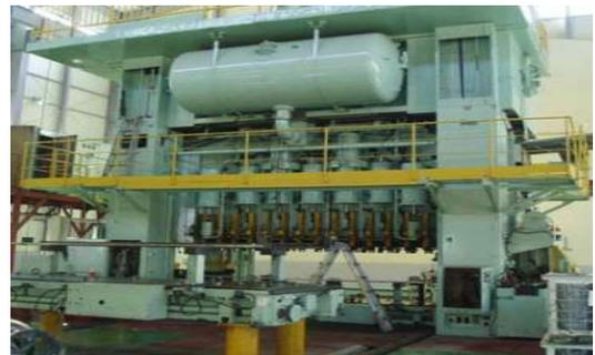
그림 6. Large press facility of 300 tons or more
