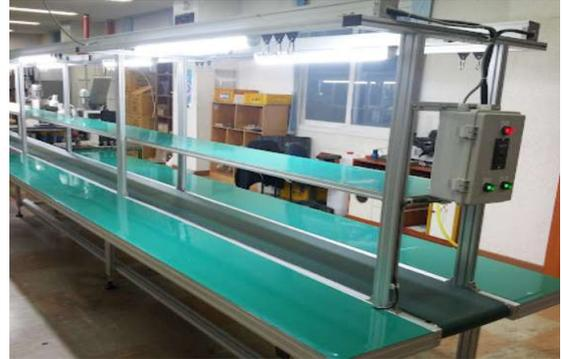
그림 5. Conveyor belt production line in assembly line
