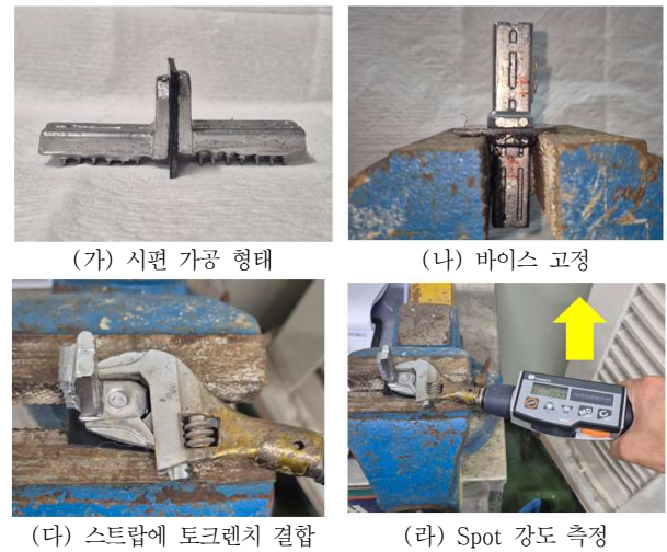
그림 2. Spot 강도 측정 절차
