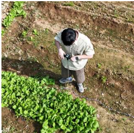
그림 6. 원추 관입계를 이용한 토양 관입 저항 측정
