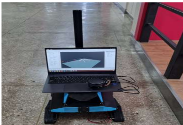
그림 3. Laptop and YDLidar X4 pro loaded on a mobile platform
