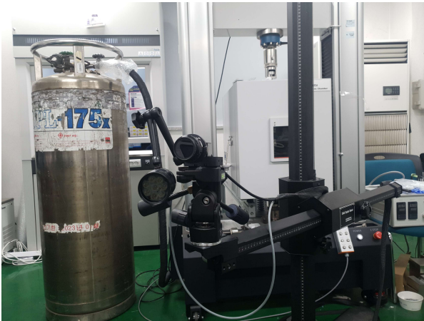
그림 2. 실제 인장 시험 촬영 환경
