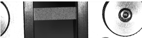
그림 3. 실제 인장 시험에서 얻어진 스펙클 패턴 이미지 시퀀스의 대표 프레임
