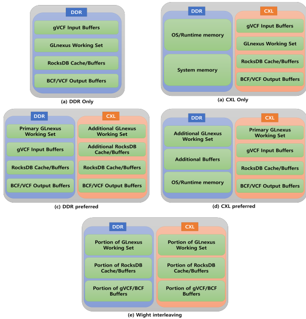
그림 2. CXL 메모리 배치 정책에 따른 GLnexus 작업 데이터의 메모리 배치 구조
