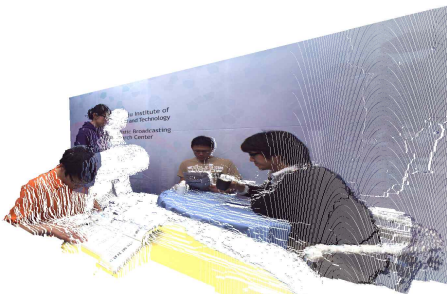
그림 10. 색상 및 깊이 영상을 이용한 3차원 장면 복원
