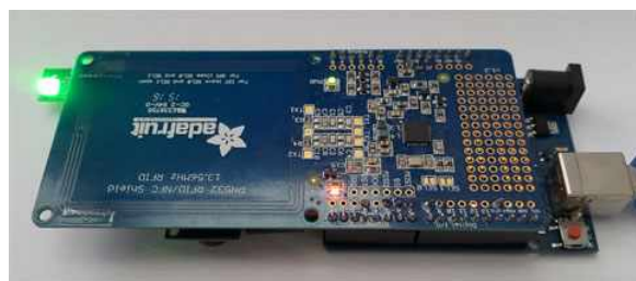
그림 1. 아두이노를 이용한 NFC Read/Write 장치
