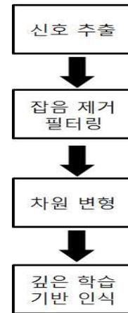
그림 3. EPS 동작신호 인식 시스템의 구성도
