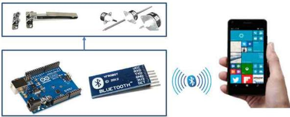
그림 4. 안전고리 스마트 제어시스템 장비 구성
