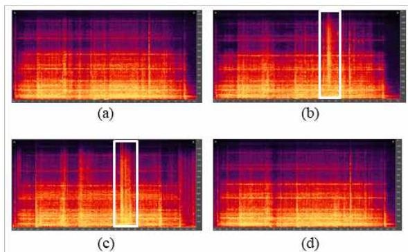
그림 11. 선로 전환기의 전환 시 소리의 스펙트로그램: (a) 정상, (b) 얼음이 낀 상황, (c) 자갈이 낀 상황, (d) 전철 막대의 나사가 풀린 상황.
