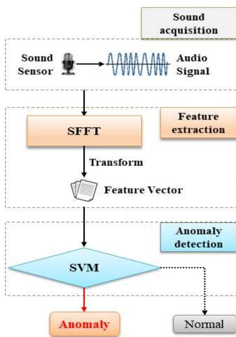
그림 2. 선로 전환기의 이상 상황 탐지시스템
