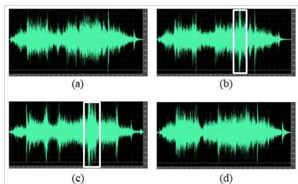
그림 10. 선로 전환기의 전환 시 소리 파형: (a) 정상, (b) 얼음이 낀 상황, (c) 자갈이 낀 상황, (d) 전철 막대의 나사가 풀린 상황.
