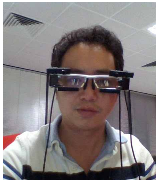
그림 2. 사용자가 Epson BT-200에 장착 된 Pupil-lab의 안구 추적기를 착용한 모습
