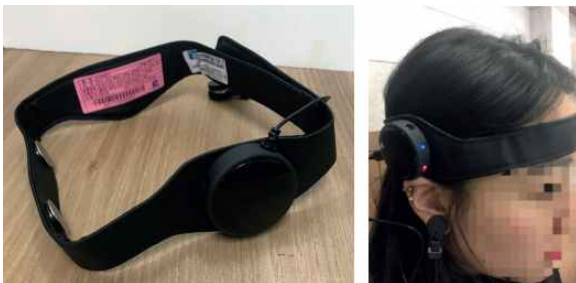
그림 3. 뇌파측정장비(BTS-3000)와 피험자 부착 모습
