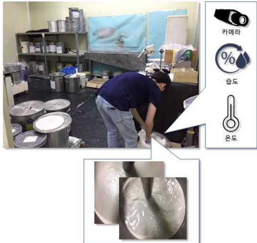
그림 10. 원료 배합 및 교반 공정의 센서들과 활용 예제
