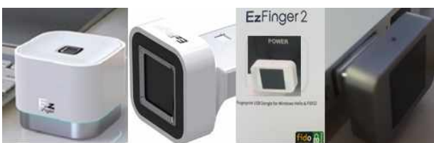
그림 7. FIDO서버 연동 생체인증용 USB모듈 분석[14]
